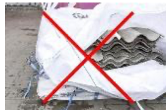
Livraison non conforme, emballage manifestement endommagé ; absence de marquage.
