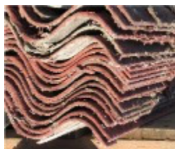
Livraison incorrecte de plaques d'amiante-ciment altérées et poussiéreuses
