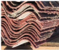
Unsachgemässe Lieferung von verwitterten, staubigen Asbestzementplatten
