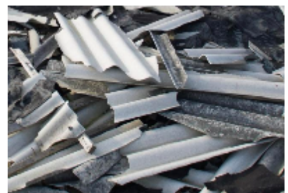
Verboten: offenes Lagern von Asbestzement
