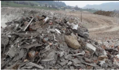
Verboten: offenes Lagern von Asbestzement
