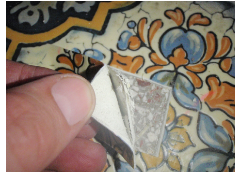
Rivestimento multistrato per pavimenti. Lo strato inferiore ha una consistenza simile al cartone e a volte si stacca spontaneamente.
