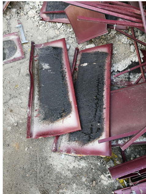
Pannelli di rivestimento di facciate muniti di rivestimento bituminoso contenente amianto. Foto: C. (Campoarmor, Arcadis Schweiz AG)
