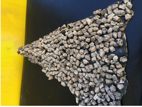
IPA, primo piano di una stuoia di scarto di sughero sotto il sottofondo, Gysi Leoni Mader
