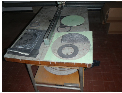
A volte, ancora oggi si possono trovare installate vecchie riserve di guarnizioni contenenti amianto. Le guarnizioni sono state tagliate a mano.
