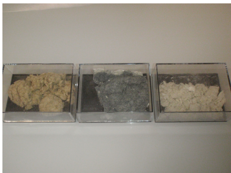
Diversi tipi di amianto floccato: da sinistra a destra: amosite (amianto bruno), crocidolite (amianto azzurro) e crisotilo (amianto bianco).
