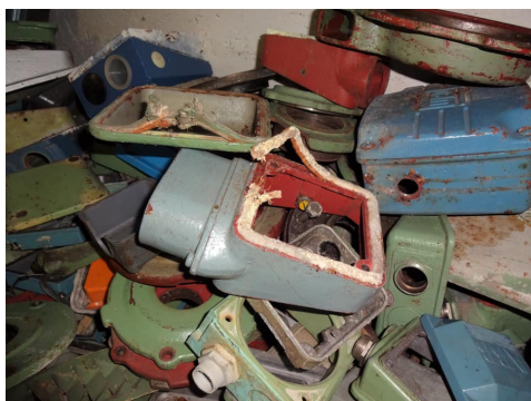
Corda di amianto in una vecchia presa elettrica da 500 Volt. (Foto: J. Meyer, Solgeo)
