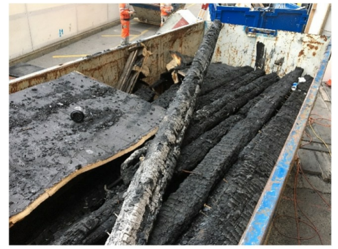
Poutres endommagées par le feu non suspectes (fraction grossière) dans une benne, Markus Durrer, IBH Expertenstelle Chur
