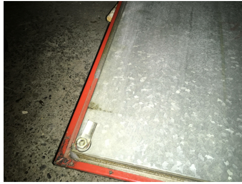
Mousse amiantée comme joint d'étanchéité pour Monobloc, Geotest
