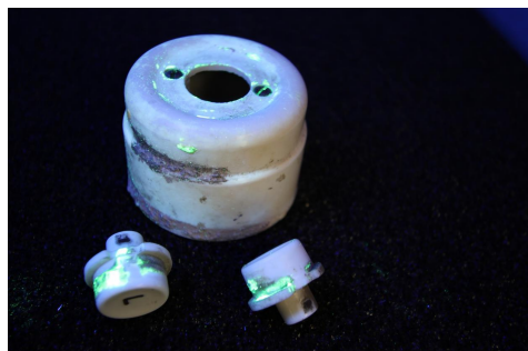
Peinture radioactive sur commutateur
