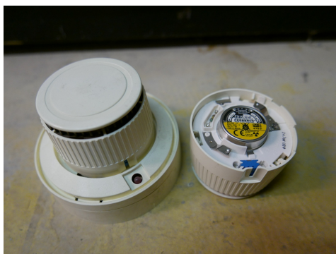
Détecteur de fumée ionisant de la marque Cerberus contenant de l'Americium. Photo: S. Schneebeli, Louis & Picadus sàrl
