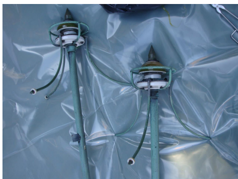
Paratonnerres radioactifs démontés. Photo: G. Di Tommaso et al., BAG
