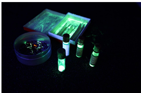
Peinture radioactive pour cadrans et les
