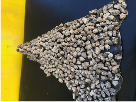
HAP natte de liège concassé sous la chape, gros plan, Gysi Leoni Mader
