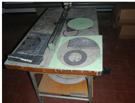
Les joints plats d'étanchéité étaient découpés à la main. On trouve encore parfois d'anciens stocks (amiantés) qui sont encore utilisés aujourd'hui.
