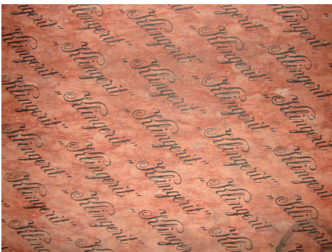
Joint d'étanchéité de la marque Klingerit contenant de l'amiante (Photo Carbotech AG)
