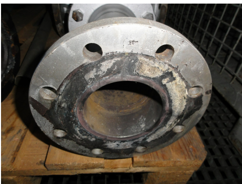
Reste d'un joint d'étanchéité. Si ces restes sont poncés, il y a un risque de libération importante de fibres d'amiante (Photo: Carbotech AG)
