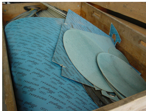
Joint d'étanchéité Klingerit bleu (éléments de découpe et plaques (Photo: Carbotech AG)
