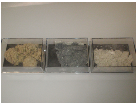
Différents types d'amiante floqué: de gauche à droite: amosite (amiante brun), crocidolite (amiante bleu) et chrysotyle (amiante blanc)
