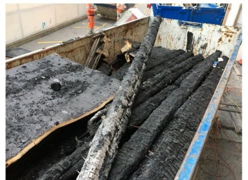
Unverdächtige angesengte Balken als Grossfraktion in einer Mulde, Markus Durrer, IBH Expertenstelle Chur
