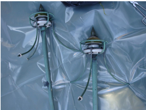
demontierte Radium-Blitzableiter. Photo: G. Di Tommaso et al., BAG
