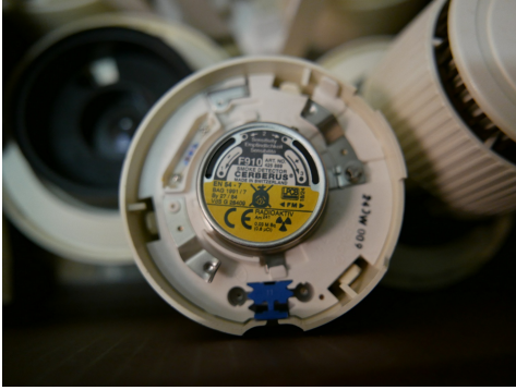
Ionisationsrauchmelder der Marke Cerberus mit Americium. Photo: S. Schneebeli, Louis & Picadus sàrl
