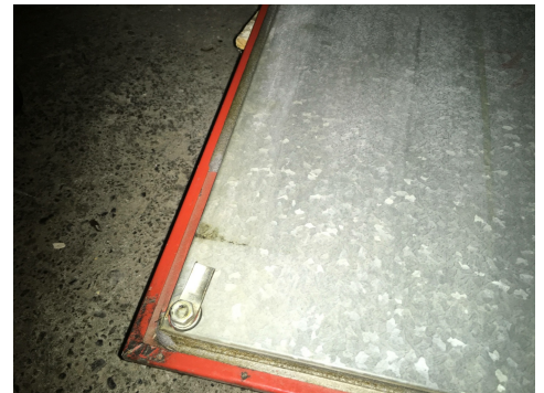
Asbest-Schaumstoff im Deckel eines Monoblocks. Photo: M. Hottarek, GEOTEST AG, 2020
