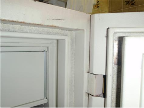
Tresor mit asbesthaltiger Dichtung in Türe
