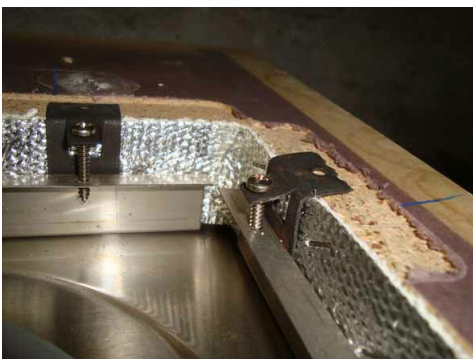
Gewebe an Unterseite Herdabdeckung, Detailansicht, Carbotech
