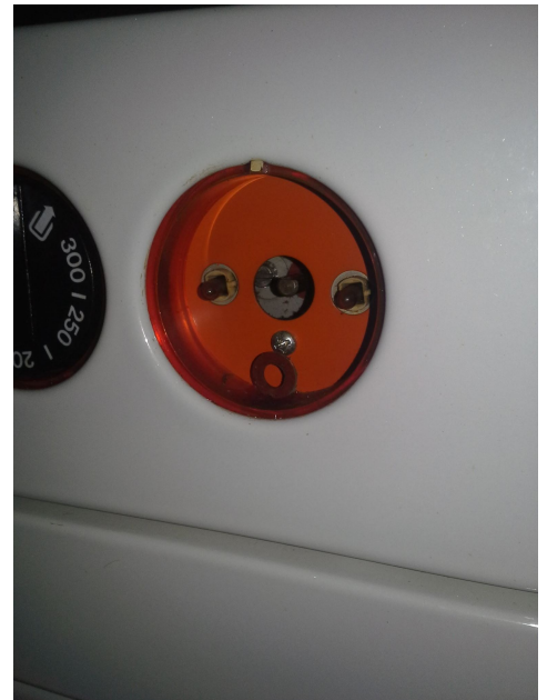
Asbesthaltige IT-Dichtung als Distanzring beim Regler eines Kochherds. Photo Bafob GmbH.
