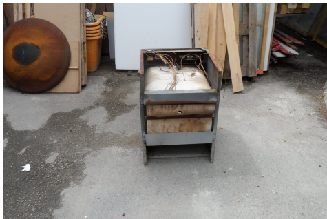
Kochherd mit asbesthaltiger Abdeckung - Photo Bafob GmbH
