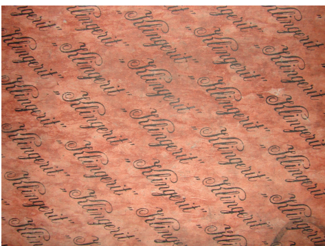
Klingerit-Dichtung rot mit Asbest Marke
