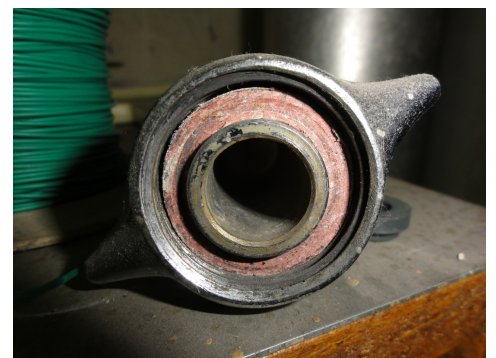
Flanschdichtung, rot in Anschluss von
