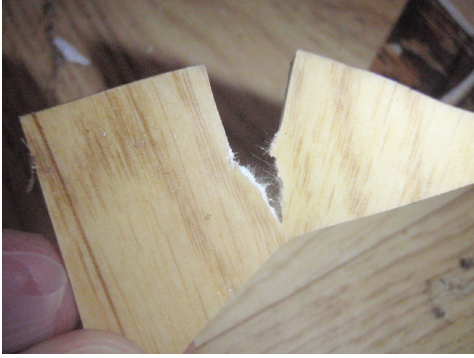
Faserarmierter PVC-Bodenbelag ohne Asbest
