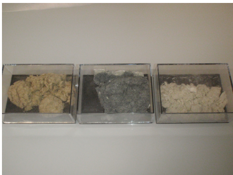
Verschiedene Arten von Spritzasbest: Von links nach rechts: Amosit (Braunasbest), Krokydolith (Blauasbest) und Chrysotil (Weissasbest)
